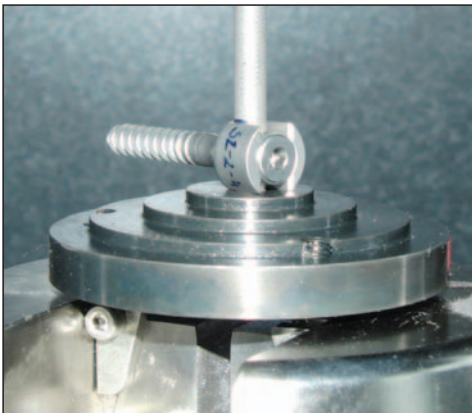
13. ábra. Gerincimplantátum és a rúd kapcsolatának stabilitásvizsgálata
