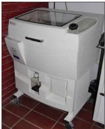
5. ábra. ZPrint 310 háromdimenziós nyomtató (a) és néhány, a sebészi célú alkalmazása során gyártott modell (b)
